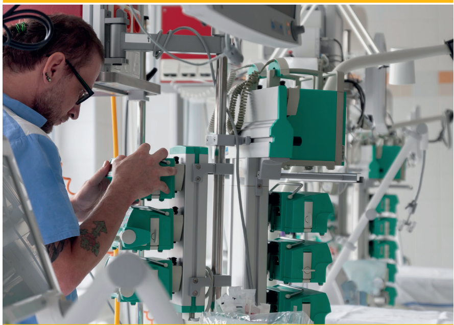
Bild 2: Die neue VDI 5707-1 zeigt die evidenzbasierte Instandhaltung aktiver Medizinprodukte am Beispiel einer Infusionsspritzenpumpe.
