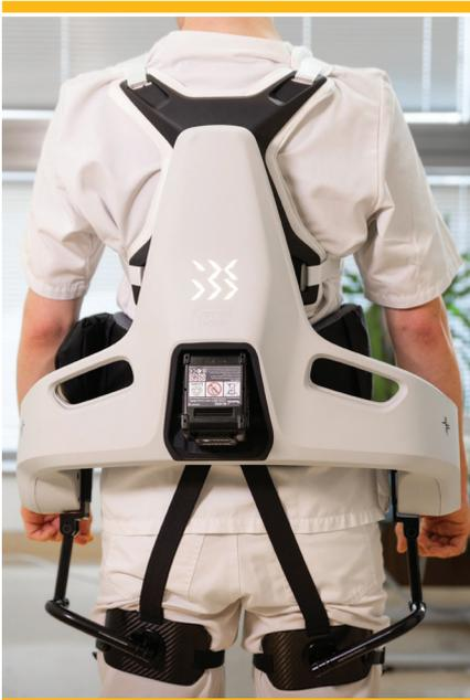
**Bild 1: Das Exoskelett „Apogee+“ unterstützt Pflegekräfte bei schwerer körperlicher Arbeit.**
